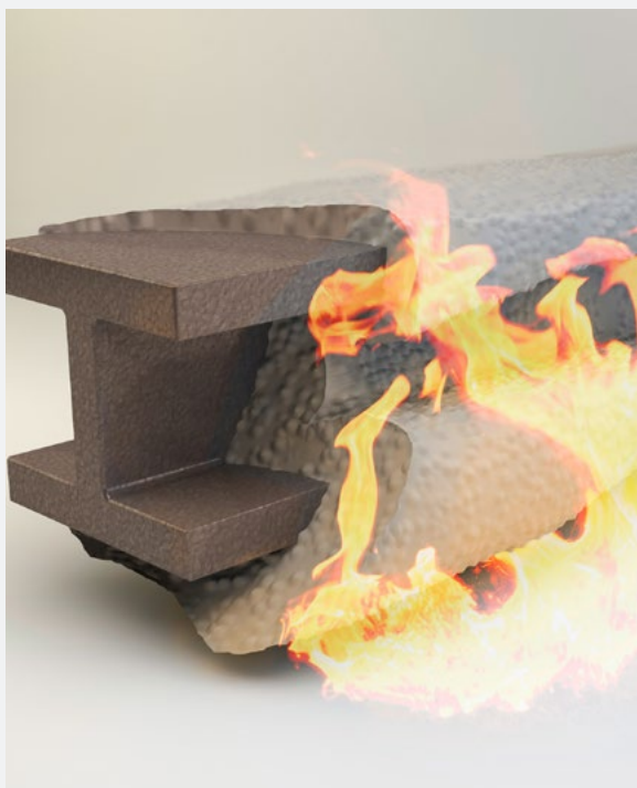
Reaktive Brandschutzbeschichtungen schäumen im Brandfall auf und bilden eine mehrere Zentimeter dicke, feinporige Schutzschicht.
