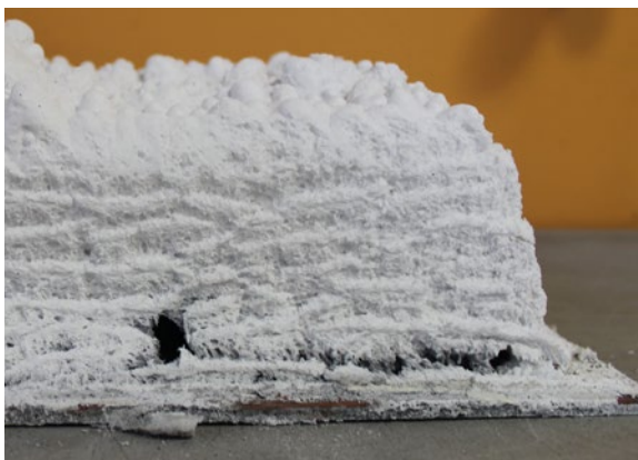
Brandschutzbeschichtungen bilden im Brandfall einen isolierenden Kohlenstoffschaum, der die Erwärmung des Stahlbauteils verzögert.
